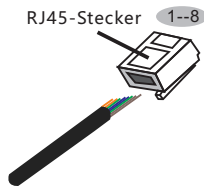
Abbildung 3.22 Isolierung entfernen und an RJ45-Stecker anschließen
